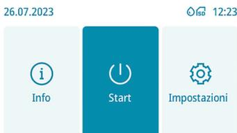
*Nota: Il dispositivo viene azionato tramite lo schermo a sfioramento o tramite la manopola rotante (ruotare per selezionare, premere la manopola per confermare). Per informazioni dettagliate sul funzionamento, consultare la sezione "Comandi".*
